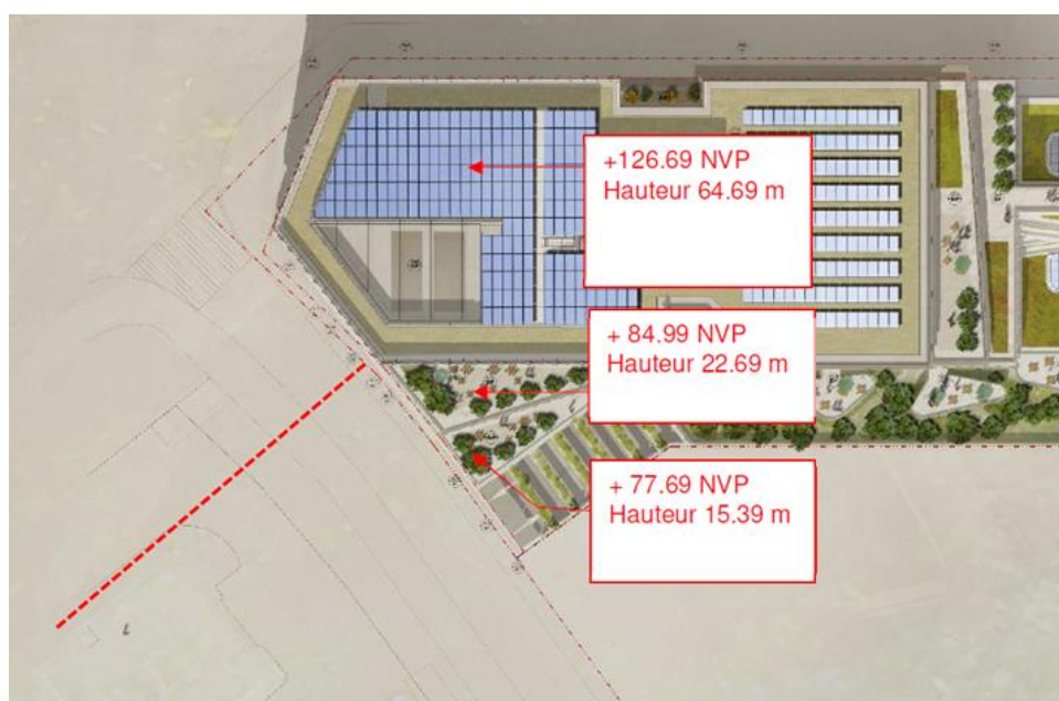
Figure 12 : Hauteur des différentes toitures faisant donnant sur l'avenue Larousse
